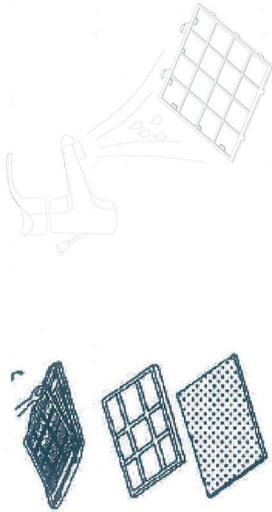
Sie können den Filter nun getrennt vom Filtergitter reinigen. Setzen Sie alle (getrockneten) Teile nach der Reinigung wieder zusammen.
